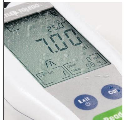
Affichant un indice de protection IP67, les FiveGo résistent aux environnements humides et exigeants. Avec leur mallette de transport compacte, ils constituent la solution idéale pour réaliser des mesures sur le terrain.
