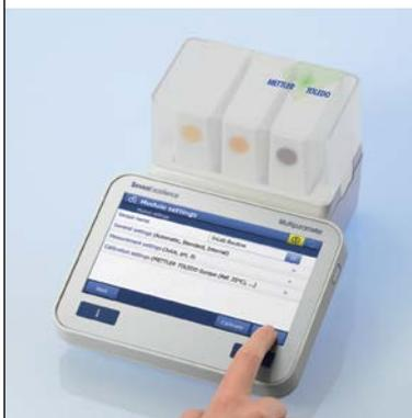
L'instrument offre une assistance à l'étalonnage à plusieurs niveaux, en proposant des méthodes à séquence d'étalonnage fixe, l'évaluation automatique des résultats de l'étalonnage avec rejet optionnel et la surveillance de l'âge et la périodicité d'étalonnage du capteur. Un étalonnage automatique avec le passeur d'échantillons Rondolino est également possible !
