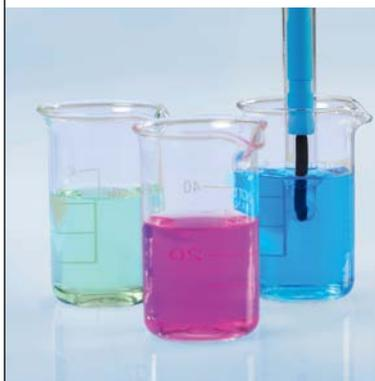
L'utilisation des méthodes est un moyen sûr et efficace d'étalonner un capteur de pH. Une fois la méthode créée, chaque étalonnage utilisera des paramètres identiques. Il est possible de surveiller les limites de décalage et de pente pour éviter l'enregistrement d'une mauvaise calibration.
