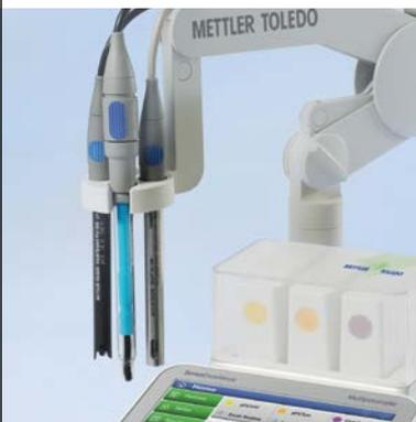
SevenExcellence permet de mesurer simultanément 1, 2 ou 3 paramètres, sur un même échantillon ou différents. Pour des mesures multiparamètres sur un même échantillon, vous pouvez également désigner le signal de température à utiliser pour tous les modules.
