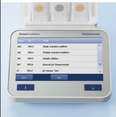
Des méthodes spéciales sont également incluses pour les techniques de mesure de concentration ionique par incréments les plus courantes, comme différentes méthodes d'ajout/de soustraction d'étalons et d'échantillons. Cela vous donne un ensemble d'outils polyvalents et modernes pour effectuer des mesures professionnelles de concentration ionique !
