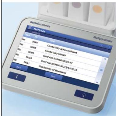
En plus d'être plus sûres, plus reproductibles et plus commodées, les méthodes vous permettent aussi d'exécuter des applications spéciales pour mesurer la conductivité. Cela comprend les mesures USP/EP de l'eau pure avec surveillance des limites et les mesures de cendres conductimétriques selon deux réglementations ICUMSA.
