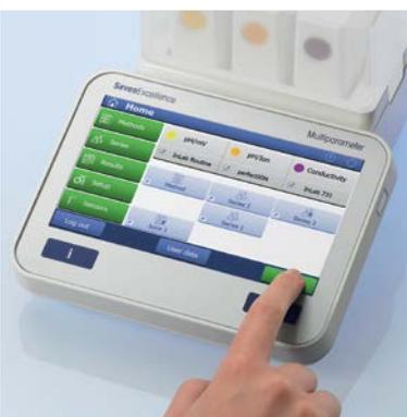
Cet appareil offre aussi la possibilité de lancer une mesure ou un étalonnage en appuyant sur READ ou CAL. Offrant d'avantage de souplesse, effectuer des mesures directes successives de différents paramètres, n'exclut pas de changer ceux-ci avant chaque échantillon.
