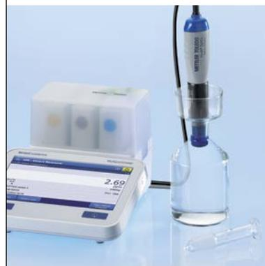
La teneur DBO de toutes les eaux usées peut être rapidement vérifiée. Avec l'adaptateur spécial DBO, le capteur est adéquat pour la mesure dans tous les flacons DBO ordinaires. Conformément à l'EPA (Environmental Protection Agency, USA), une agitation n'est pas nécessaire grâce à la technologie RDO. Avec le kit S900-BOD, vous êtes paré.
