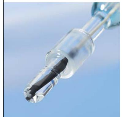
SevenExcellence permet de contrôler les performances d'un capteur de pH. Le test de capteur par type de méthode particulière guide l'utilisateur à travers les différentes étapes, en contrôlant diverses caractéristiques de mesure, comme la dérive et la répétabilité.
