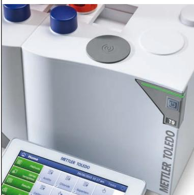
SmartChemicals est un produit innovant proposé par METTLER TOLEDO pour renforcer le concept de flux de travail continu. Toutes les données chimiques pertinentes, telles que le nom, le numéro de lot ou la date d'expiration sont stockées dans la puce placée sous l'étiquette du produit chimique et transférées vers le titreur grâce au lecteur Smart intégré. Le flux de données automatisé garantit la précision et l'exhaustivité des données tout en permettant à l'opérateur de gagner du temps.
