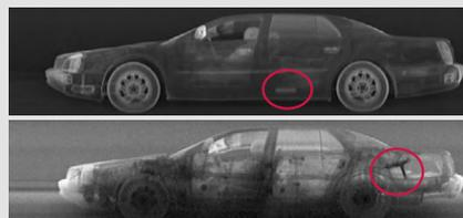
SUPÉRIEUR : Côté gauche Z Vue rétrodiffusée
