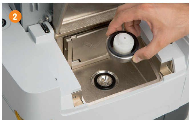
Placez votre échantillon sur la position de mesure
