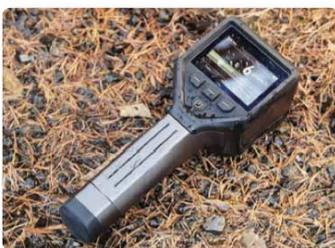
Conforme aux normes ANSI N42.42 et ANSI N42.34, et doté d'un boîtier de protection robuste IP67, le **spectromètre IDENTIFINDER R440** a été conçu pour résister aux chocs et aux environnements les plus exigeants.
