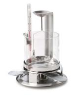
La détermination de la masse volumique d'échantillons solides et liquides devient un jeu d'enfant grâce à ce kit pour balances d'analyse et de précision.
