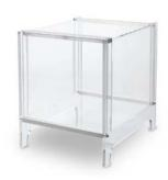
Le pare-brise protège votre balance des courants d'air pouvant altérer sa stabilisation (par ex., la climatisation).
