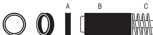
A : Joint (remarque : le bord ouvert est placé face à l'extérieur) B : Dispositif de retenue du joint C : Assemblage du piston
