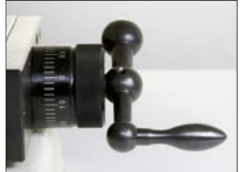
**Particulièrement précis :** le plateau coulissant de précision du broyeur à disques FRITSCH PULVERISETTE 13 *classic line* permet un ajustement exact de l'écartement à 0,1 mm près – pour un traitement rapide, précis et dans des conditions reproductibles.
