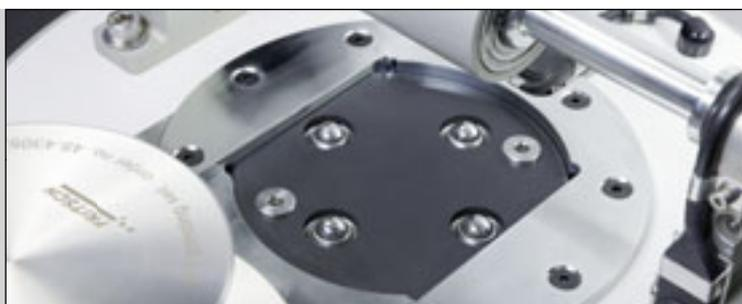
La garniture de broyage est soulevée automatiquement par un système à pression. Sa bonne position est maintenue grâce à un dispositif de blocage et contrôlée par un contacteur.
