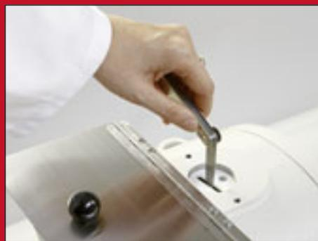
**Particulièrement pratique :** contrôle aisé de l'écartement de l'extérieur (avec une jauge d'épaisseur par ex.)
