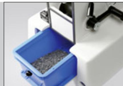
Broyage de roches basaltiques avec le broyeur PULVERISSETTE 1 *classic line* (modèle II), écartement position 2 – Avant/Après
