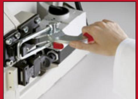
**Très sûr :** verrouillage centralisé de la chambre de broyage
