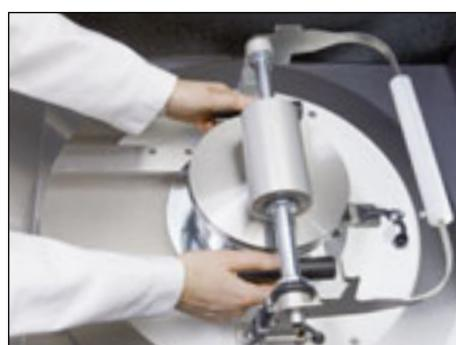
**Particulièrement ergonomique :** Les garnitures de broyage de la PULVERISSETTE 9 se mettent en place sans aucune difficulté grâce à une rainure faisant office de guide. Il suffit ensuite de pousser jusqu'en butée. Le poids a été considérablement allégé et l'opérateur est à bonne hauteur pour travailler dans les meilleures conditions.
