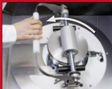
**Particulièrement sûr :** Dispositif de serrage entièrement nouveau de la garniture de broyage : fixation complète avec la poignée en un tour de main.
