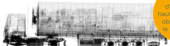
Exemple d'image RX haute résolution obtenue avec le Eagle M60
