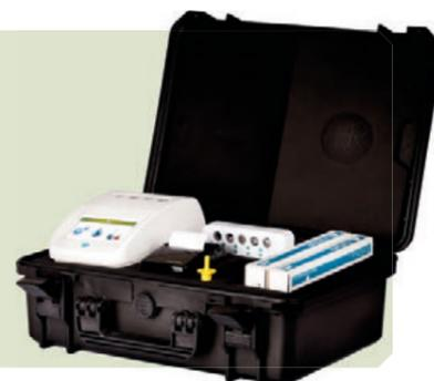
CDR OxiTester permet d'effectuer rapidement des contrôles de la qualité dans toutes les phases de la filière de production de l'huile d'olive, en permettant d'évaluer les paramètres dans les fruits, les pâtes et directement dans l'huile.
